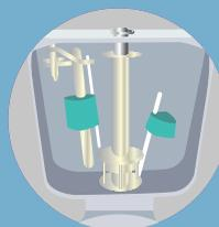
> Ensemble du **mécanisme de chasse d'eau** des WC depuis le robinet d'arrêt jusqu'au point de raccordement entre le réservoir et la cuvette (flotteur, robinet d'arrêt, chaînette, guide, joints, etc.).
